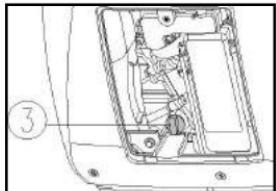
5. Установите на штатное место технологическую крышку и затяните фиксатор.
