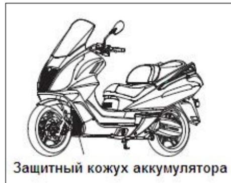
Защитный кожух аккумулятора
